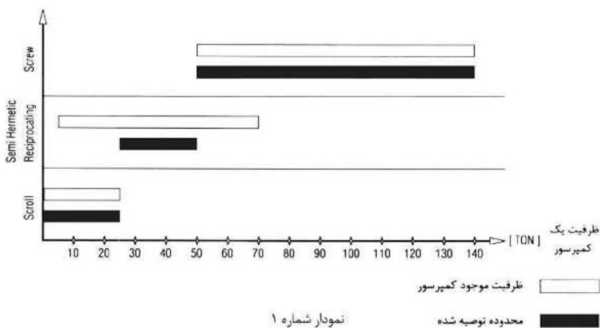
نمودار مذکور مربوط به چیلرهای تک کمپرسوره می‌باشد ، چنانچه چیلرهای ۲ و چند کمپرسوره را نیز در نظر بگیرید ، دیده می‌شود که در تمامی تراشه‌ها ، کمپرسورهای رفت و برگشتی قابل حایگزینی با انواع Scroll Screw با Screw می‌باشد .
