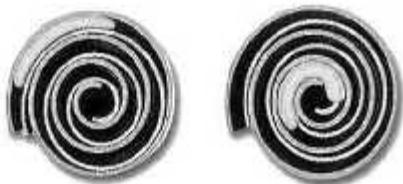
شکل ۲: نحوه عبور مایع از کمپرسور Scroll :
